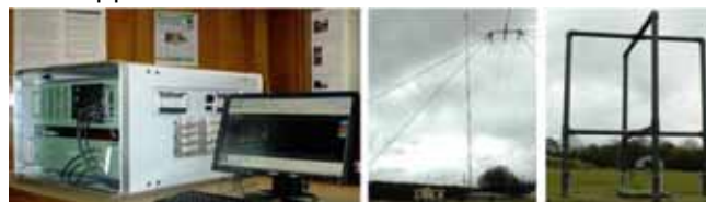
Figure 43 : La Digisonde-4D (à gauche), l'antenne émettrice (au milieu) et l'antenne de réception (à droite).
