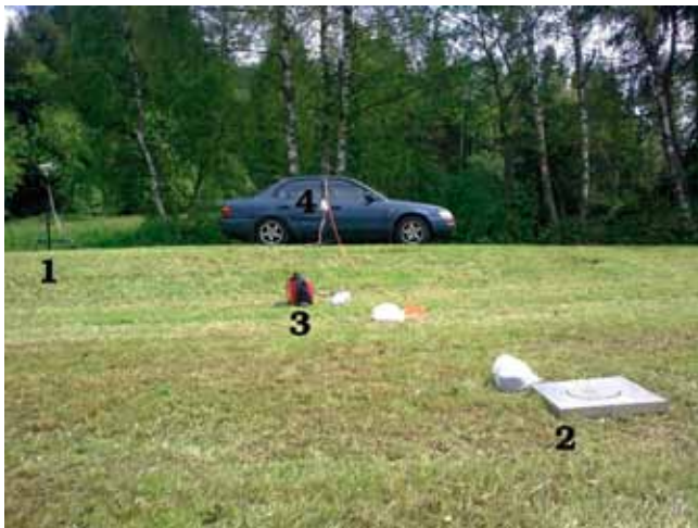
Figure 9 : dispositif avec (1) une caméra à haute vitesse (2) un instrument pour mesurer le champ électrique (3) un générateur d'électricité et (4) un GPS.
